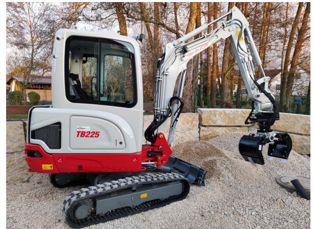
Takeuchi Kompaktbagger TB 225 A V3 mit Powertilt und hydraulischer Schnellwechsler
